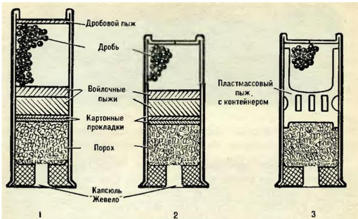
На дробовых прокладках пишут номер дроби, иногда год снаряжения патрона. Снаряженные и завальцованные патроны в бумажных и пластмассовых гильзах надо прогнать через обжимку; металлические же гильзы обжимают до снаряжения патронов.
