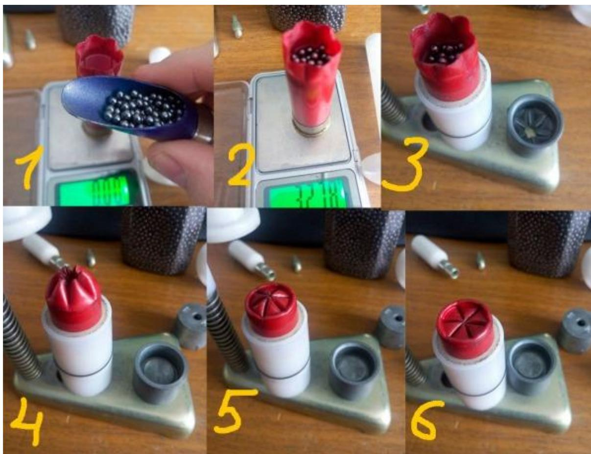
Следующий этап заключается в снаряжение снарядом. Это дробь или пуля. Сверху на дробовой заряд укладывается дробовой картонный пыж, он закрывает дробь и на него наносится маркировка. В пулевых патронах пыж на пулю не ставится во избежание подминания его пулей, что может привести к деформации ствола.
