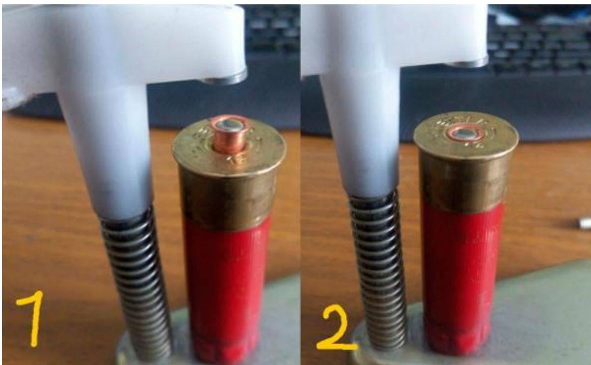
Первый этап заключается в запресовке капсюля. В металлических гильзах ранее использовался только капсюль Центробой на основе гремучей ртути. Сейчас производятся латунные гильзы 12 калибра и под Жевело. Рационально применять для этого прибор для снаряжения патронов, а не молоток или ложку. Такой дикий способ запресовки увеличивает риск повреждения капсюля и отказа его в самый неподходящий момент на охоте.
