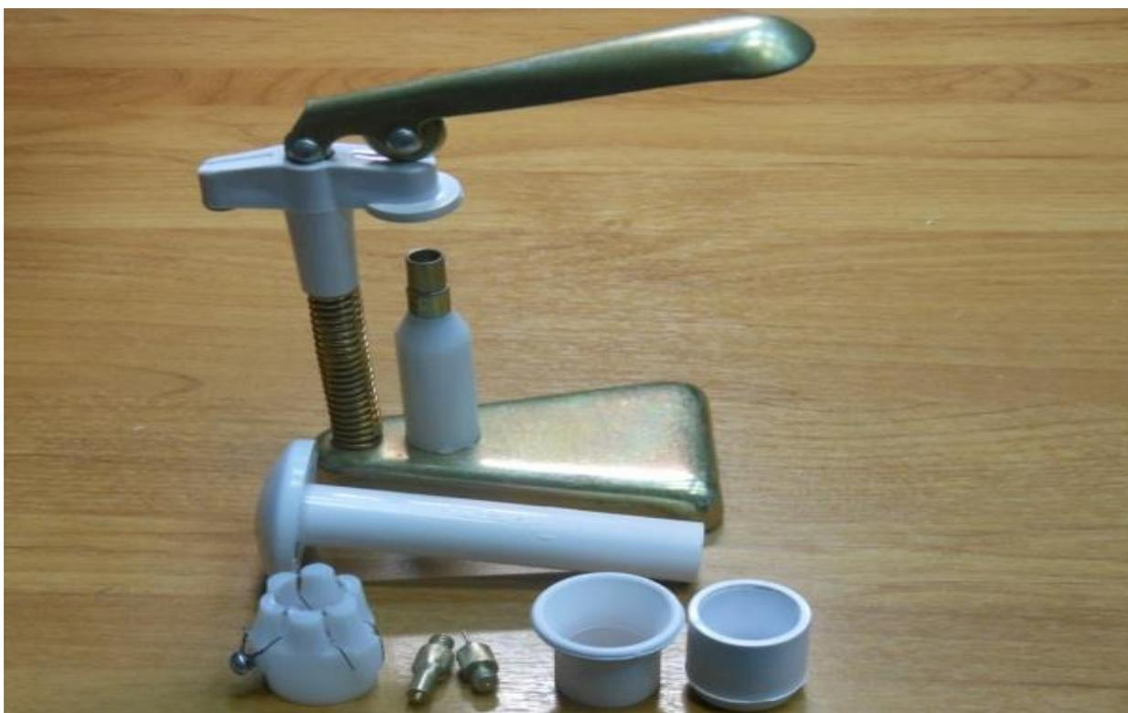
Идеальный станок для зарядания патронов представляет собой ручной пресс для запресовки капсюля, досылки прокладок и пыжей в гильзе и закручивания или завальцовки дульца гильзы.
