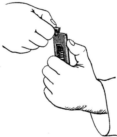
Рис. 53. Снаряжение магазина патронами
