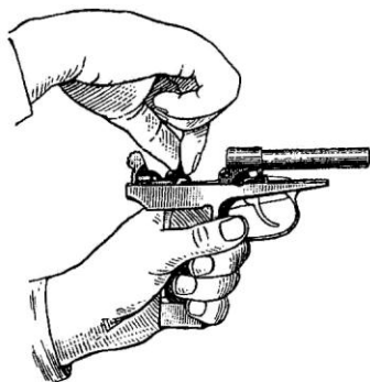
Рис. 24. Присоединение затворной задержки и шептала к рамке
