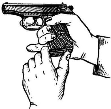
Рис. 3. Извлечение магазина из основания рукоятки
